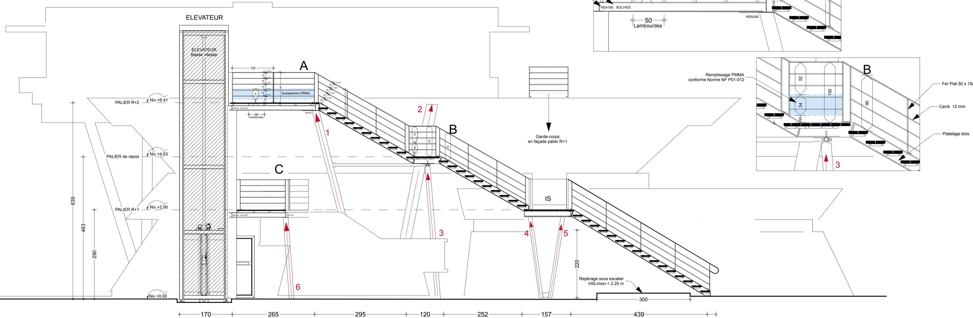
Remplissage PMMA conforme Norme NF P01-012
