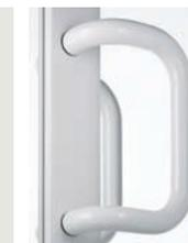
**Variante 4** : La manœuvre s'effectuera par poignée de tirage double type *aileron vertical* en aluminium, hauteur 300mm, à fixations invisibles (Sépalumic réf.45390). Ces poignées seront de teinte : .....
