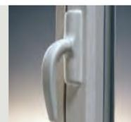
**Variante 1 :** Compte-tenu du verrouillage *inversé* la manœuvre s'effectuera par poignée à clef à tourner, en aluminium, et à fixations invisibles (Sépalumic réf.: 40422). Cette poignée, tournée vers le bas, indiquera la position fermée, en horizontale, permettra l'ouverture à soufflet, et orientée vers le haut (après décondamnation avec la clef), autorisera l'ouverture à la française. Ces poignées seront de teinte : .....
