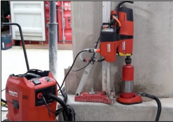
Figure N°3 : carotteuse et recycleur d'eau HILTI
