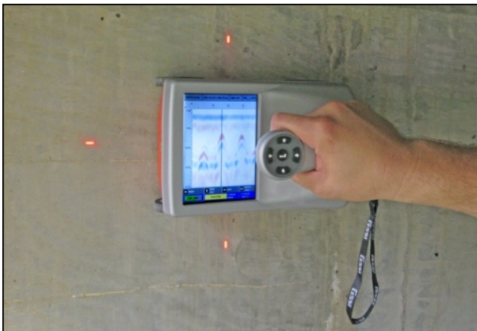
Figure N°2 : géoradar StructureScan GSSI
