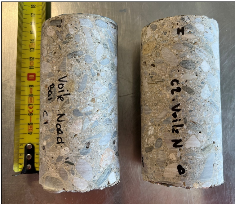
Photographie carotte C1 et C2 côté Nord
